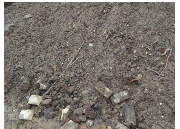
Foto 6: aangetroffen puin, geen asbestverdacht materiaal
